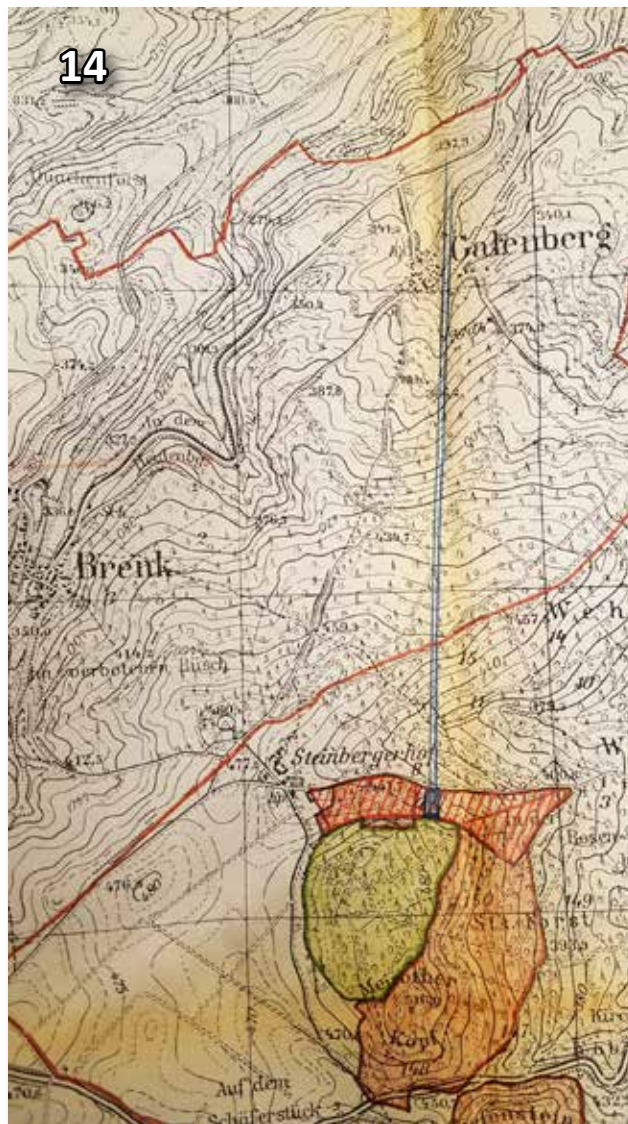
Bild 14: Über mehr als 20 Jahre wurde eine Seilbahn von Oberzissen zum Basaltbruch Meirother Kopf bei Wehr geplant, aber nie realisiert. Der Verlauf der Seilbahn und die Verladestation sind in einer Karte von 1958 blau eingezeichnet. Diese Bahn hätte den Ort Galenberg überspannt. Bild: aus dem Aktenbestand der BEG
