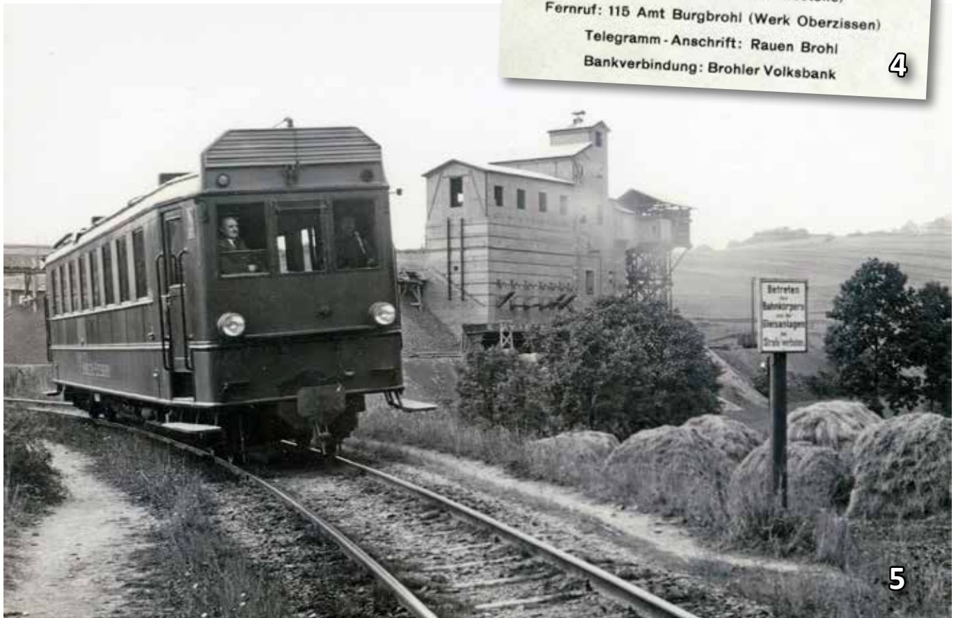
Bild 5: Der 1925 von den Deutschen Werken in Kiel (DWK) gelieferte, 150 PS starke Benzoltriebwagen 50 der Brohltalbahn vor der Kulisse des im gleichen Jahr in Betrieb genommenen Schotterwerks in Oberzissen. Bild: IBS-Archiv
